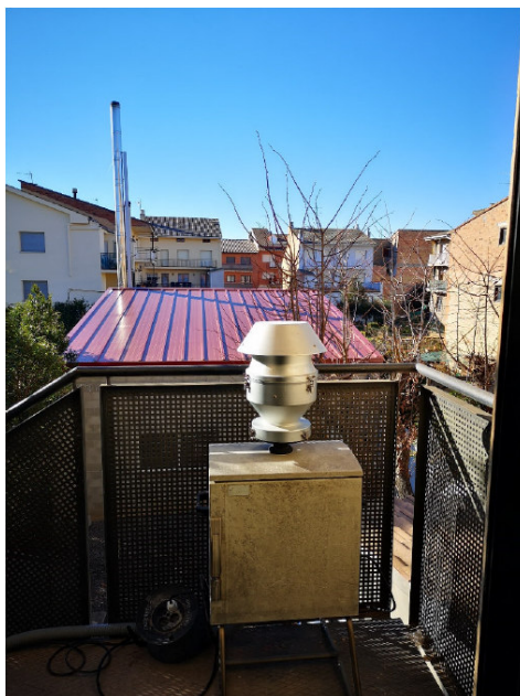
Figura 11. Muestreo con captador secuencial de alto volumen (Fuente: Diputació de Barcelona)
